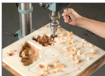
Quite el material utilizando una broca Forstner de 50,8mm en una taladradora de columna.
