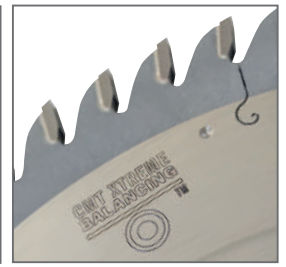
Fig. 2 Ejemplo de una sierra revisada y ya perfectamente equilibrada.
