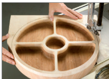
Trabaje la parte exterior de la bandeja utilizando una sierra de cinta.
